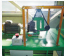
危険体感設備(巻き込まれ)
