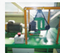
危険体感設備(巻き込まれ)
