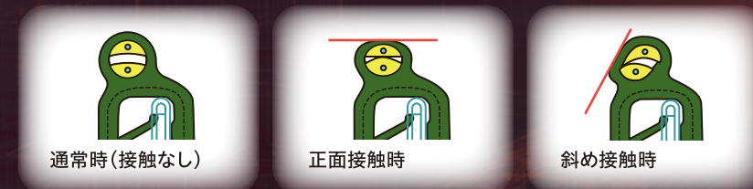
〈挟み込み接触時の中空部変形の様子〉
